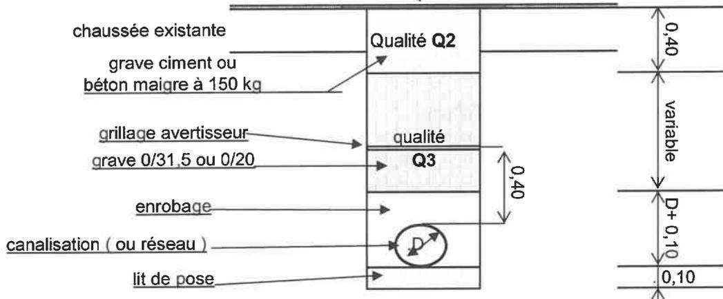
La qualité de compactage exigée pour une chaussée donnée est modulée en fonction du rôle de la couche au sein de l'ouvrage et trois niveaux de qualité sont ainsi déterminés pour les matériaux de remblaiement et les matériaux de chaussée.
