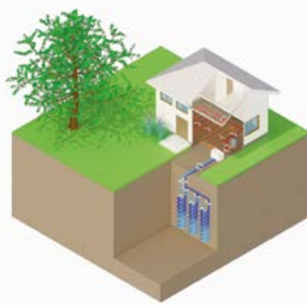
Pompe à chaleur sur corbeilles géothermiques
